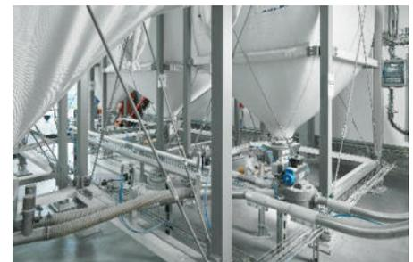
Nach den Sprühtürmen gelangt das fertige Produkt über eine Saugförderung in 4 weitere A.B.S-Fertigwarensilos. Die dafür eingesetzten Abscheider trennen das bearbeitete Produkt von der Förderluft und haben eine Leistung von 500-600 kg pro Stunde.
