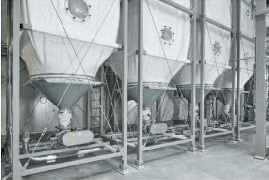
Da das fertige Produkt anders als das Granulat schwierig ausläuft, muss bei der Entnahme nachgeholfen werden. Um Brückenbildung zu vermeiden und einen sicheren Auslauf zu gewähren, sind die A.B.S.-Fertigwarensilos hier mit Vibrationsböden und Rüttelmotoren ausgestattet. Zellenradschleusen dosieren das Produkt im richtigen Verhältnis zur Förderluft in die Saugförderung ein und garantieren so optimale Fließbedingungen.
